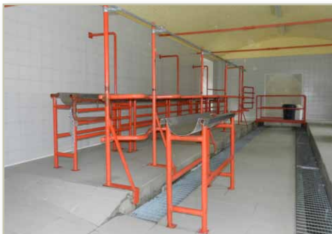
Figura 17. Esempio di una sala di mungitura con diverse poste per le asine.
